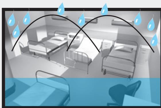
**SEM-SAFE®** utiliza hasta un 50% menos de agua en comparación con los sistemas de agua nebulizada a baja presión y hasta un 80% menos de agua en comparación con los rociadores convencionales..
